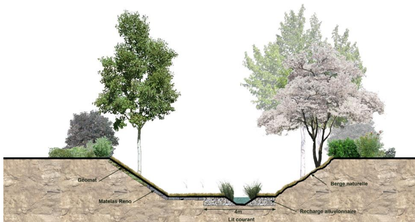
Figure 7 : Coupe type du lit du Rieumassel après réalisation du projet – Source : AVP
